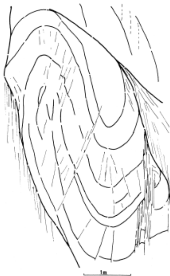
Fig. 28. Pliegue de F1 limitado por superficies de cizalla. Carretera de Leiza a Hernani. Km. 44. (Según foto).
