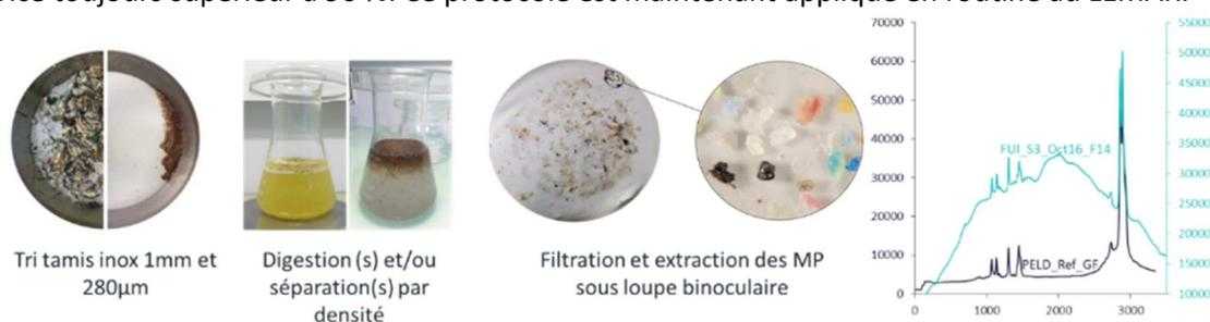
Figure 7 : Schéma synthétisant les différentes étapes réalisées pour l'extraction des microplastiques dans des échantillons d'eau de surface.
