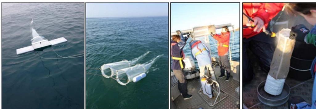
Figure 4 : Filet Manta (à gauche), filet double neuston (milieu gauche), nettoyage du filet et récupération de l'échantillon sur un tamis en inox de maille 300 µm (à droite).
