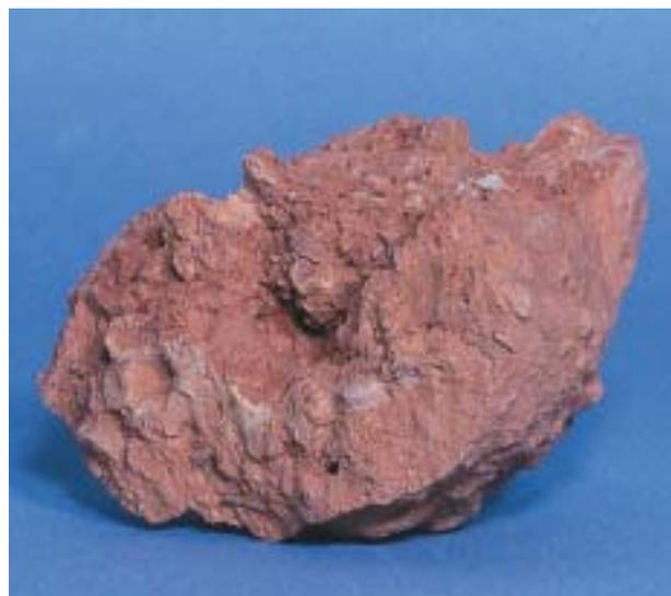
**d.** Échantillon d'argilites rouges prélevé dans le talus de Vitrolles.
