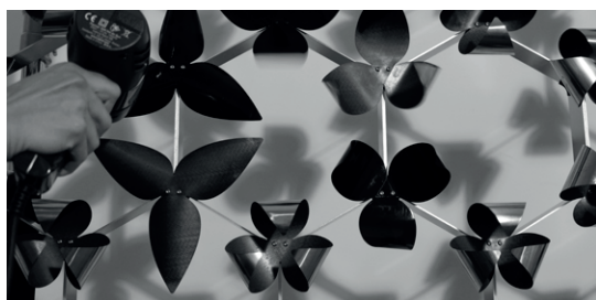
Modules de façade PHO'LIAGE ® en position ouverte et fermée suivant la température du métal constituant les modules © ArtBuild
