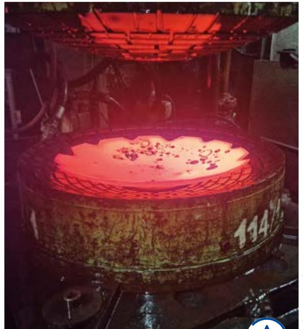
Mise en forme à chaud de disques agricoles.
